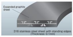
그림과 같이 Standing Edge 가공을 한 SUS316철판을 팽창흑연 사이에 끼운 Sheet를 타발 가공한 Gasket 입니다.
